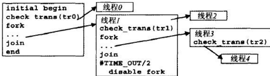
图 7.4 fork...join 方框图
